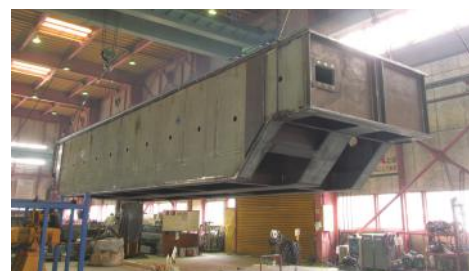
■発電所向け放水路制水ゲート(新潟県)
