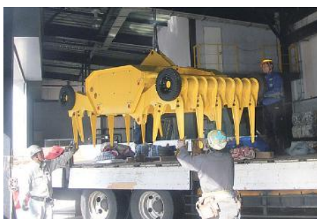
■バケットクレーン点検・整備
