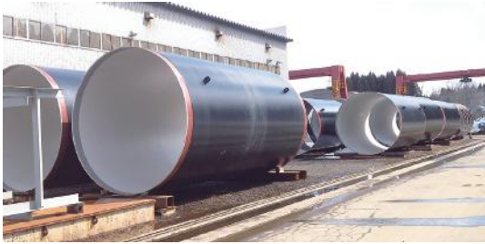
能代火力 取放水管(平成28年)
